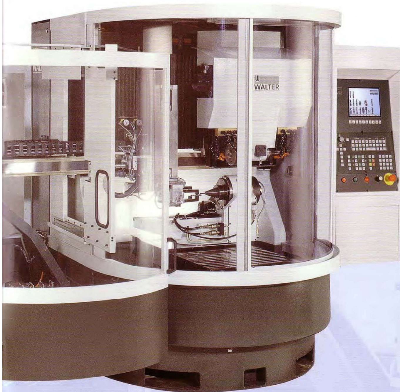
HHelitronic Power R Hmc500 Com carregador de produção para retificação automática da produção em vários turnos. A retificadora é programada para o próximo palete enquanto a retificação das ferramentas no palete é concluída. O ciclo de retificação começa imediatamente após a troca de palete.
