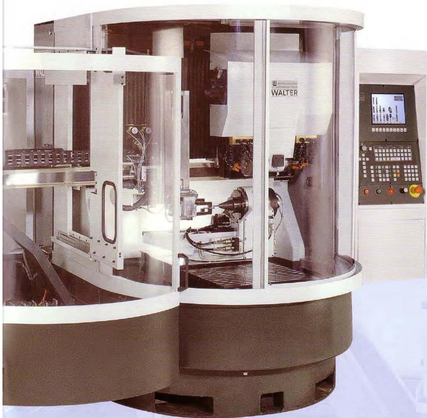
Helitronic Power Production com carregador de produção para retificação automática de produção em vários shifts. A retificadora é programada para o próximo paleta enquanto a retificação das ferramentas no paleta é concluída. O ciclo de retificação inicia imediatamente após a troca de paleta.
